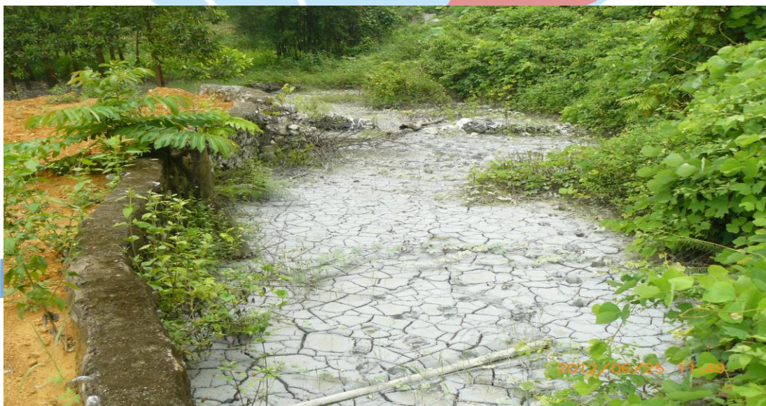
Hình 3: Đuôi quặng Chì – Kẽm (Mỏ Lang Hích) từ hồ chứa tràn ra suối
